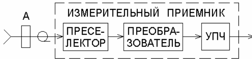
Рис.21. Структура измерителя напряженности поля
